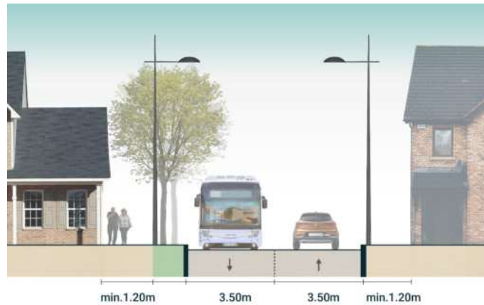
Fig. 44 Exemplo de perfil-tipo para arruamento urbano estruturante
