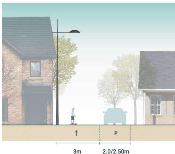
Fig. 42 Exemplo de perfil-tipo para zona de coexistência
