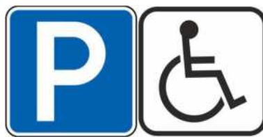
Fig. 145 Sinal regulamentar H1a (parque de estacionamento) com o painel anexo modelo 11d (portador de deficiência ou mobilidade reduzida) Fonte: Sinalnorte
