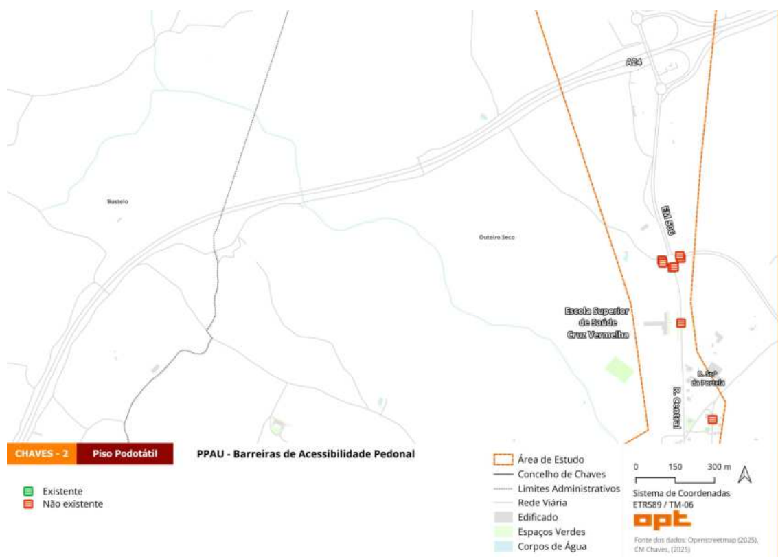
Fig. 101 Identificação das passadeiras com piso podotátil (02 – Escola Superior de Saúde)
