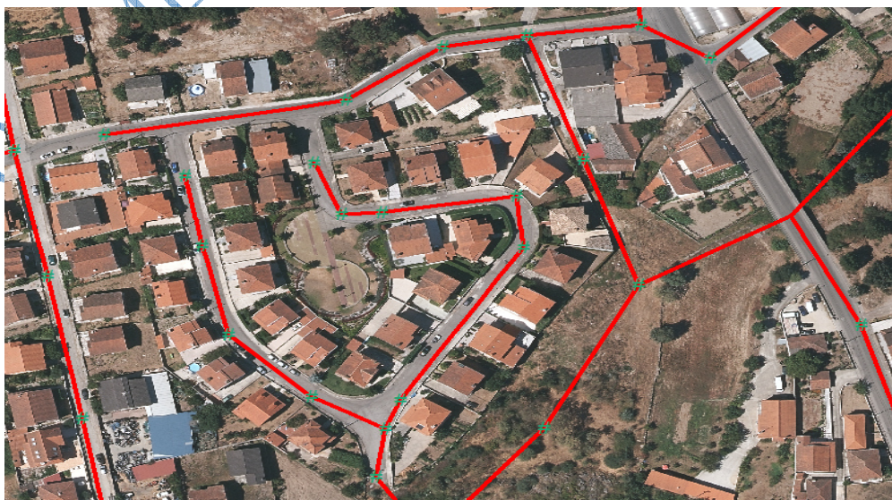
Figura 2 - Rede de águas residuais domésticas
